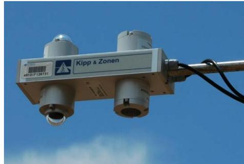
Figure 13. CNR-1 net radiometer
