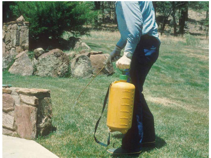
Figura 4. Un pulverizador de bomba manual se utiliza comúnmente para aplicar plaguicida diluido en agua alrededor de césped y jardín.
